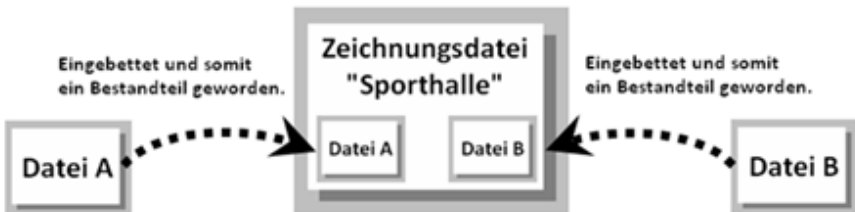
Bild: Die externen Dateien „A“ und „B“ werden in die Zeichnungsdatei „Sporthalle“ referenziert und eingebettet (Option „[ ] einbetten“ aktiviert). Die beiden Dateien werden als Zeichnungselement „Referenz“ Bestandteil der Zeichnung und sind unabhängig von ihrer Vorlage geworden. Ein Abgleich kann allerdings jederzeit ausgeführt werden, wenn sich z. B. die Originalvorlage geändert haben sollte und übernommen werden soll.
