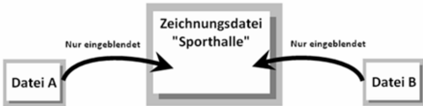
Bild: Die externen Dateien „A“ und „B“ werden in die Zeichnungsdatei „Sporthalle“ referenziert und deren Inhalt eingeblendet. Die Zeichnungsdatei merkt sich die Ablage der referenzierten Dateien. Ohne die Kenntnis der korrekten Ablage könnte der Inhalt der referenzierten Datei nicht angezeigt werden (siehe „Falsche Referenzen“).
